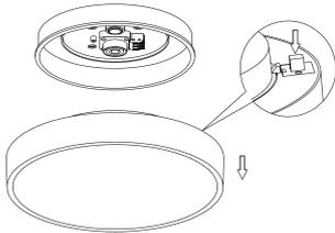
2.1 Öffnen Sie die Gummidichtung der Montageplatte soweit, bis das Stromkabel hindurch passt.
