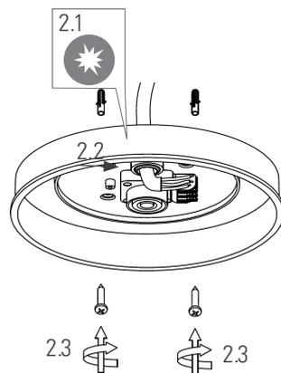
3. Schließen Sie das Stromkabel an die Steckklemme der Leuchte an.
